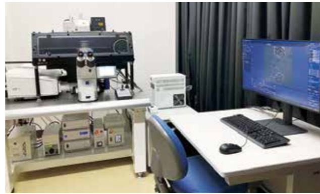
超解像共焦点レーザー顕微鏡LSM980 with AiryScan2:生細胞もダメージを少なく120nmの分解能で超解像イメージングが可能。
