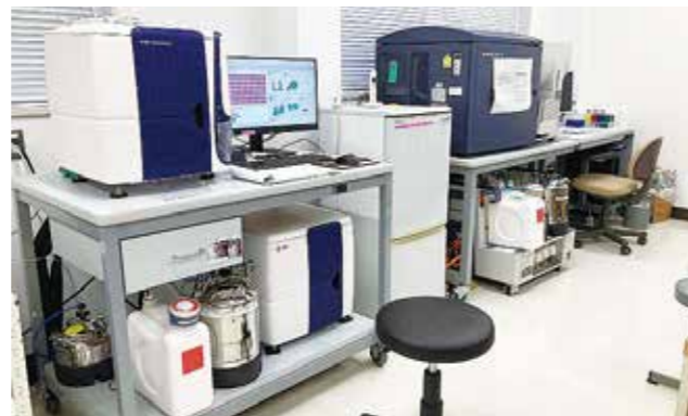
写真右奥 セルソーター FACS Aria III:生体中の微量な細胞群を高速に選別し取得することができる。 写真左手前 セルソーター FACS Melody:細胞1個からの選別取得を行うシングルセルソートにも対応。
